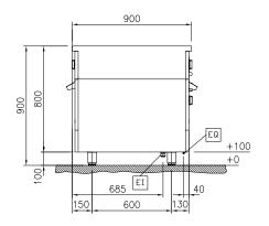
Electrical inlet (power) **Equipotential screw**
